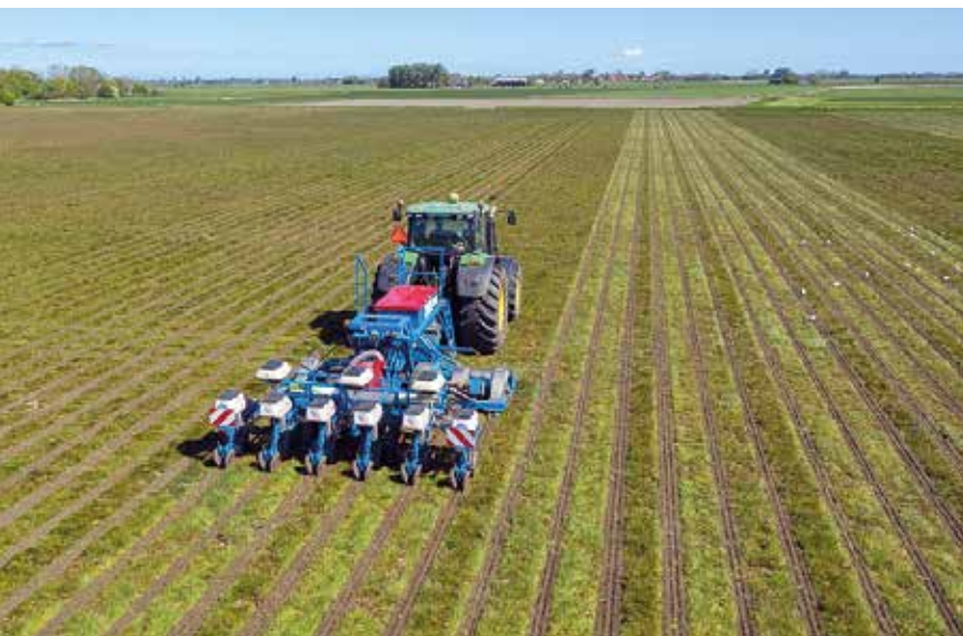
Zandvliet heeft ook veel energie gestoken in het strokenfreen voor de maïs en daar een eigen machine achter de trekker voor laten bouwen en daarmee goed gescoord.
